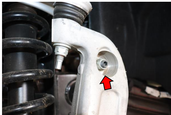
2. Remove 18mm sway bar end link nut.
