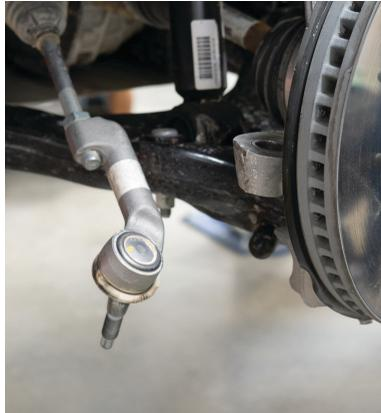
Fig. 2: Tie rod end link.
