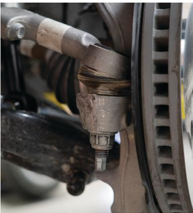
Fig. 16: Tie rod end link.
