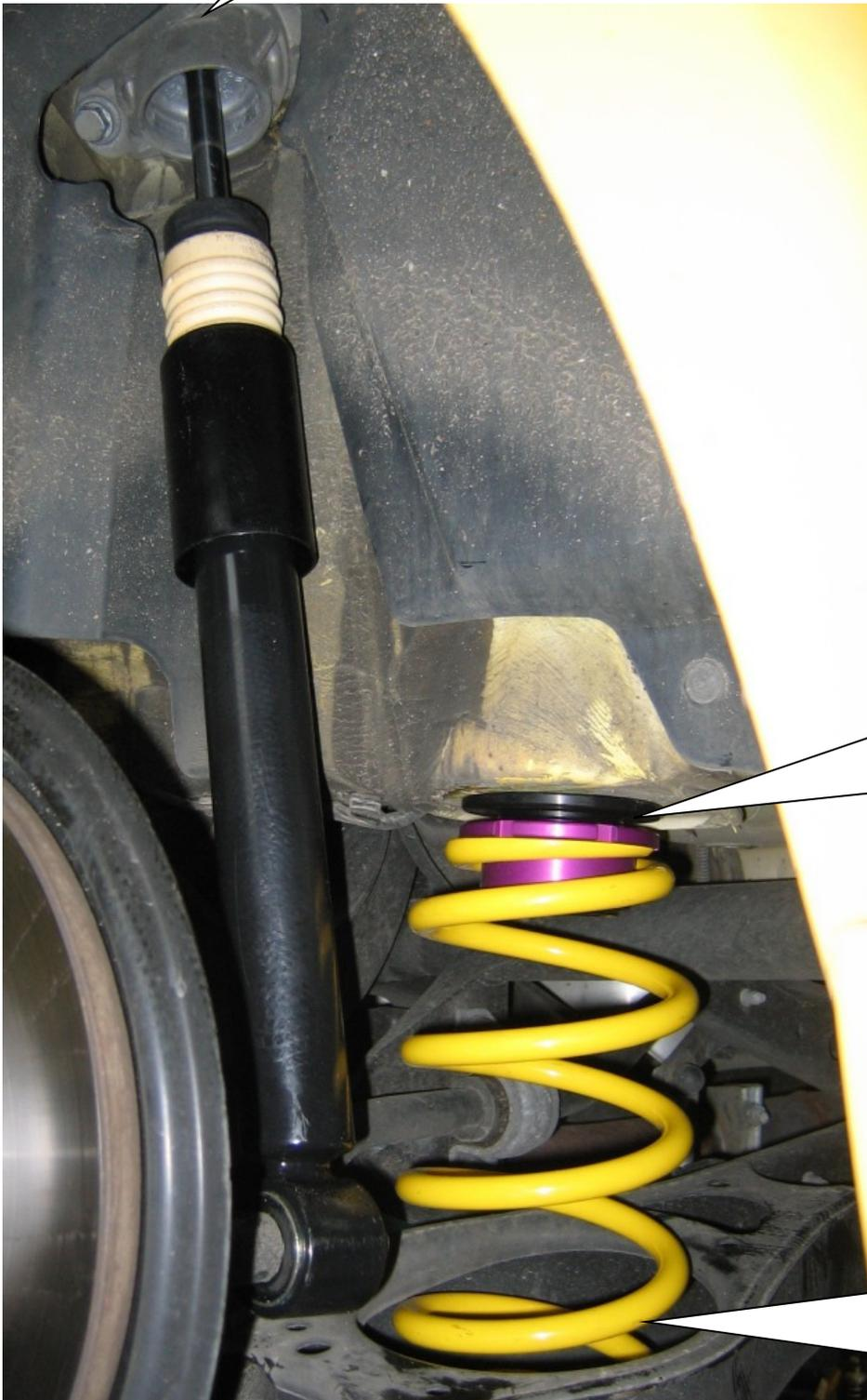
Mitgelieferte Höhenverstellung wird oben, ohne Gummiunterlage zwischen Karosserie und Feder montiert.
