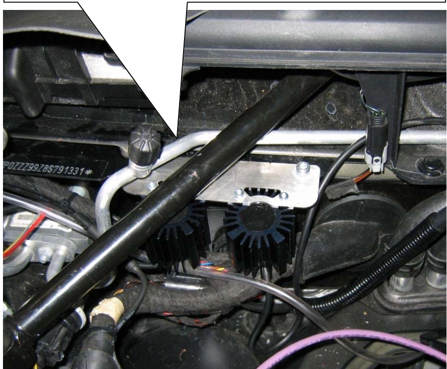
350 mm Leitung für rechts 350 mm wire for the right 1000 mm Leitung für links 350 mm wire for the left
