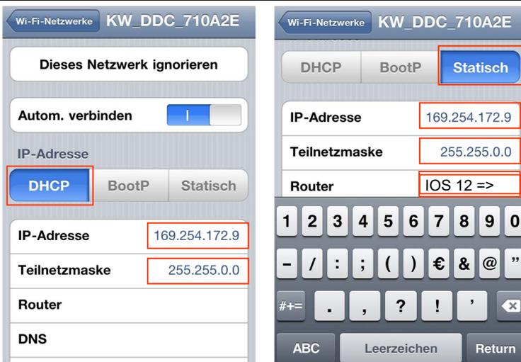
Für eine schnelle automatische Verbindung muss die IP Adresse fest eingegeben werden. Hierzu muss die IP Adresse im Beispiel „169.254.172.9 / 255.255.0.0“ notiert und unter Statisch eingetragen werden. Nur **ab IOS 12** muss zusätzlich im Feld Router die IP Adresse „169.254.172.9“ eingetragen werden.
