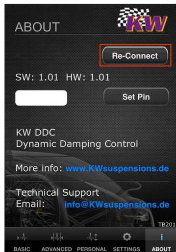
Nach der Installation der KW App muss eine Verbindung mit dem DDC Steuergerät aufgebaut werden. Dies geschieht durch drücken des „Connect“ Buttons im Menü „About“ Eine erfolgreiche Verbindung wird durch die Anzeige „Re-Connect“ angezeigt.
