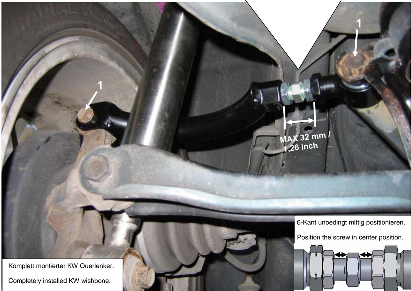
Komplett montierter KW Querlenker.
