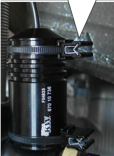
HA Elektronik Modul am Fahrzeugdom mit den Edge Clips befestigen und in den Kabelbaum einstecken. Auf die korrekte Verriegelung des Steckers achten! Leitung mit Kabelbindern am Kabelbaum befestigen.
