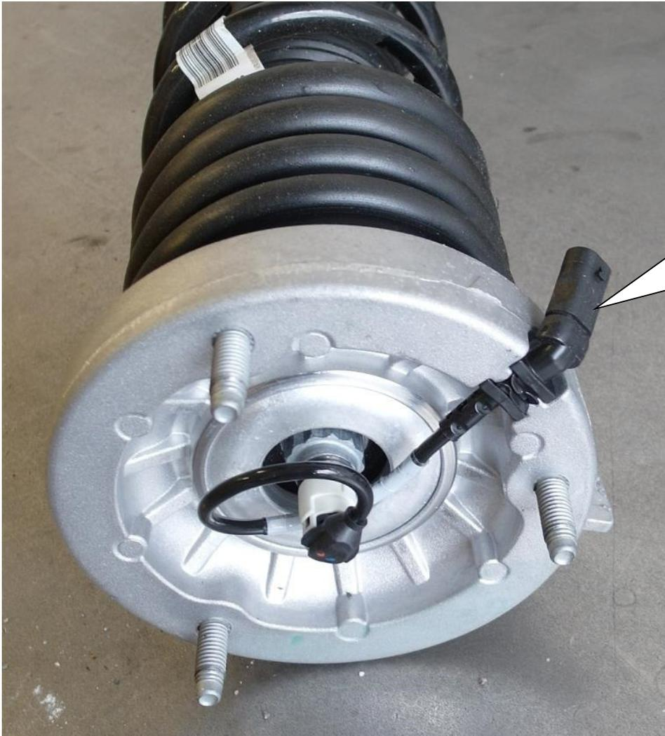
Originales Adapterkabel aus dem Stützlager demontieren. Dieses wird zwischen originalem Kabelbaum und der Stilllegung montiert.
