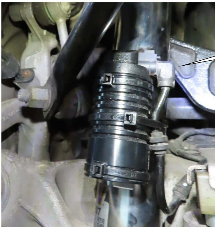
Dämpferleitung in die Stilllegung einstecken. Auf die korrekte Verriegelung des Steckers achten!
