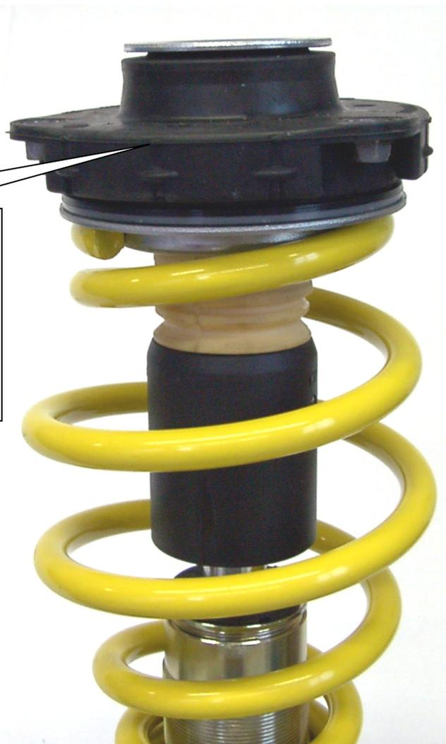
Das Original Domlager aufsetzen und mit der im Lieferumfang enthaltenen Mutter festschrauben. Das Anzugsdrehmoment der Kolbenstangenbefestigung beträgt 50 Nm. Die Montagehinweise zum Einbau des Federbeines in das Fahrzeug, sowie die Anzugsdrehmomente der Federbeinbefestigung, entnehmen Sie bitte den Unterlagen des Fahrzeugherstellers.
