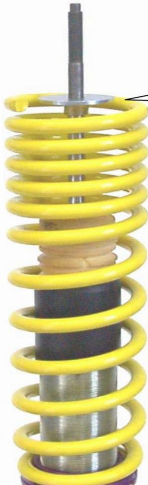
Angeliefertes Federbein mit Unterlegscheibe zum Abstützen der Dämpferkraft gegen das Stützlager. Die Original - Stützscheibe entfällt.
