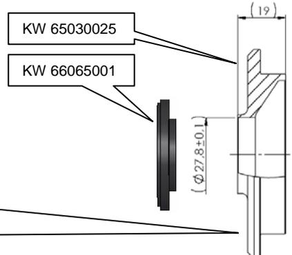
Nach erfolgtem Einbau des Fahrwerkes ist die Freigängigkeit der Bereifung zum VA-Federbein zu überprüfen. Das Mindestabstandsmaß darf an der engsten Stelle **5 mm** nicht unterschreiten und ist gegebenenfalls mittels handelsüblicher, TÜV geprüfter Distanzscheiben wieder herzustellen.
