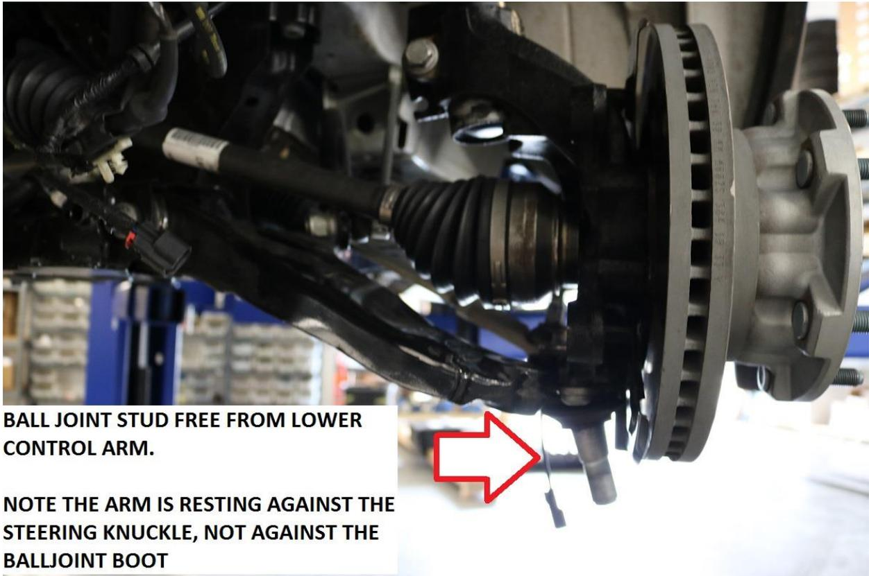
**BALL JOINT STUD FREE FROM LOWER CONTROL ARM.**
