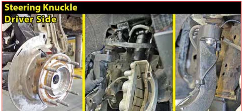
**CV AXLE NUT, BRAKE ROTOR, BRAKE CALIPERS & HUB DUST SHIELD...**
