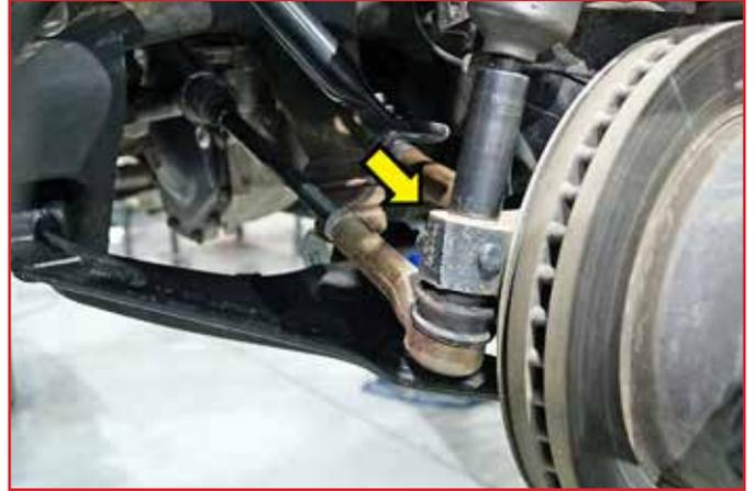
**DISCONNECT ABS BRAKE PLUG & BRAKE LINE BRACKET...**
