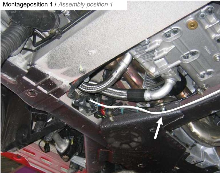
Hydraulikleitung ( 2100 mm) mit dem Verteiler verbinden.
