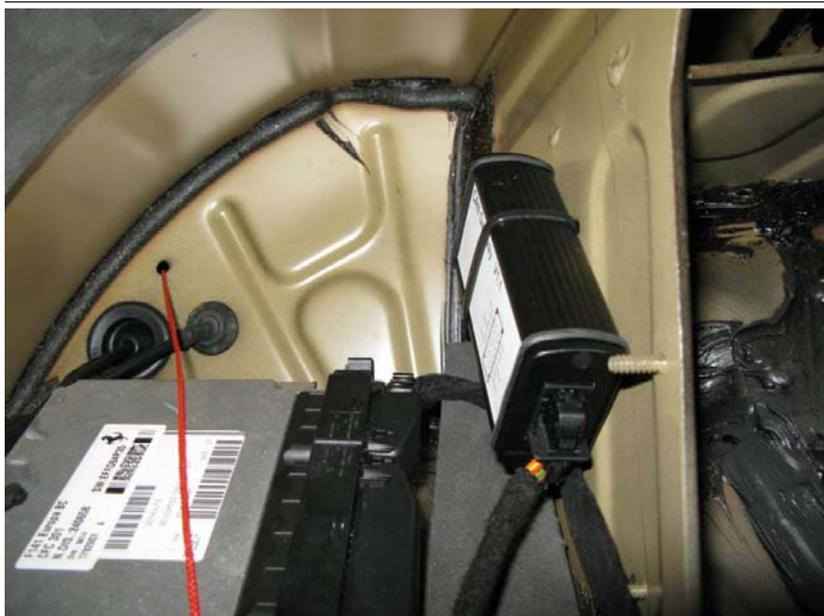
Original Fahrwerkssteuergerät demontieren.
