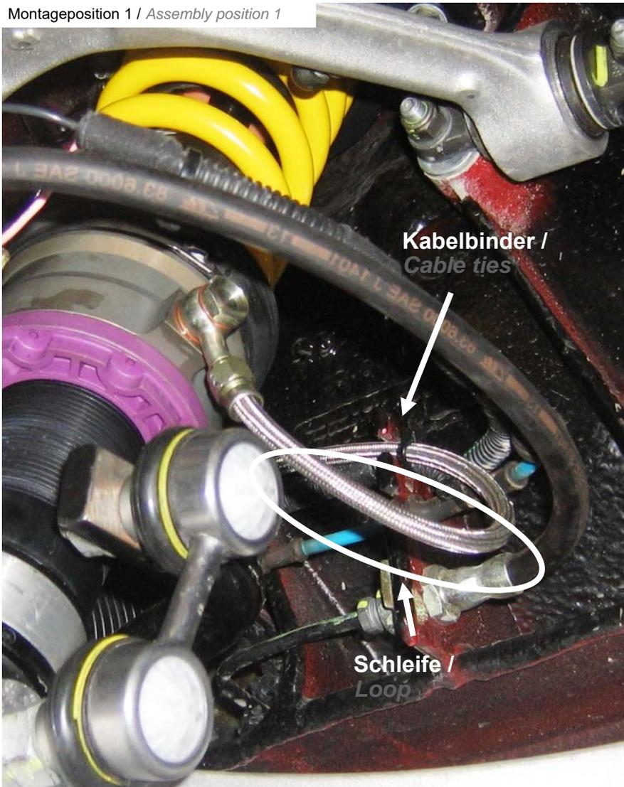
Hydraulikleitung mit Kabelbinder an dem Halter befestigen. Kabelbinder erst nach vollständiger Leitungsverlegung festziehen
