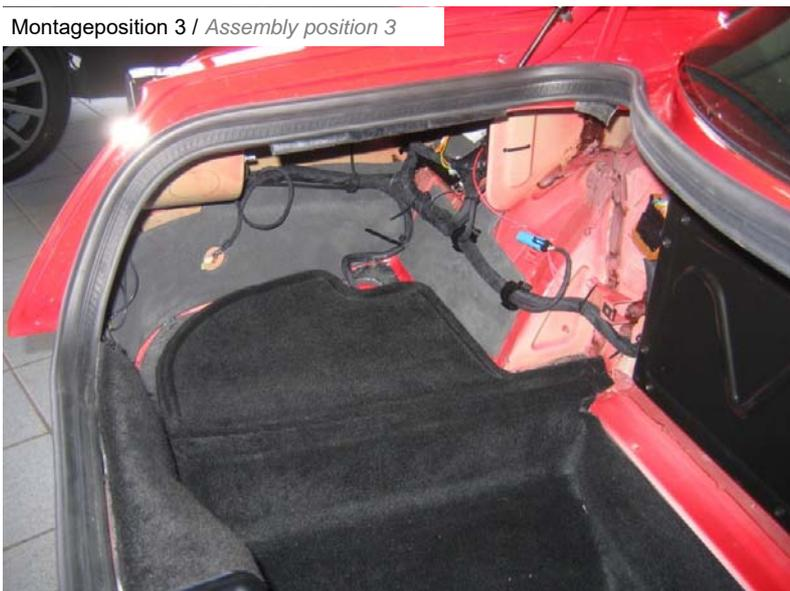
Kofferraumteppich entfernen und Hydraulikaggregat positionieren.
