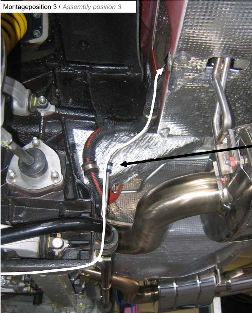
Hydraulikleitung entlang des Kabelbaums verlegen und mit Kabelbinder befestigen.
