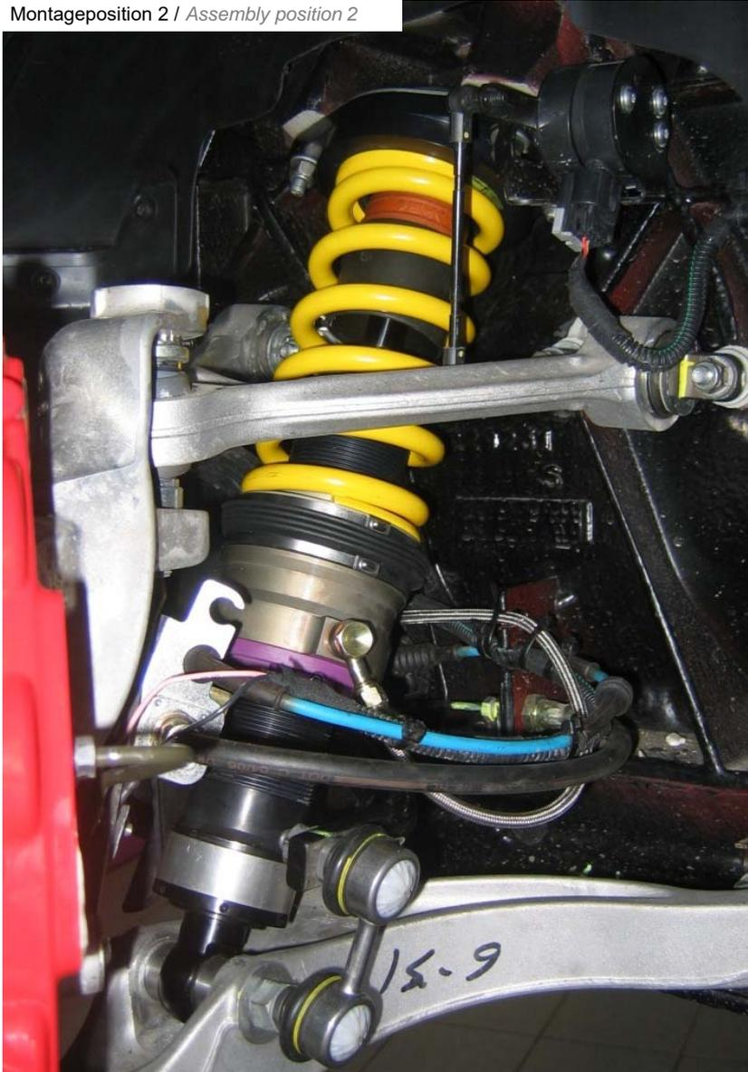
Hydraulikleitung ( 1000 mm) am HLS Ringzylinder mit der mitgelieferten Hohl-schraube und 2 Dichtscheiben montieren.
