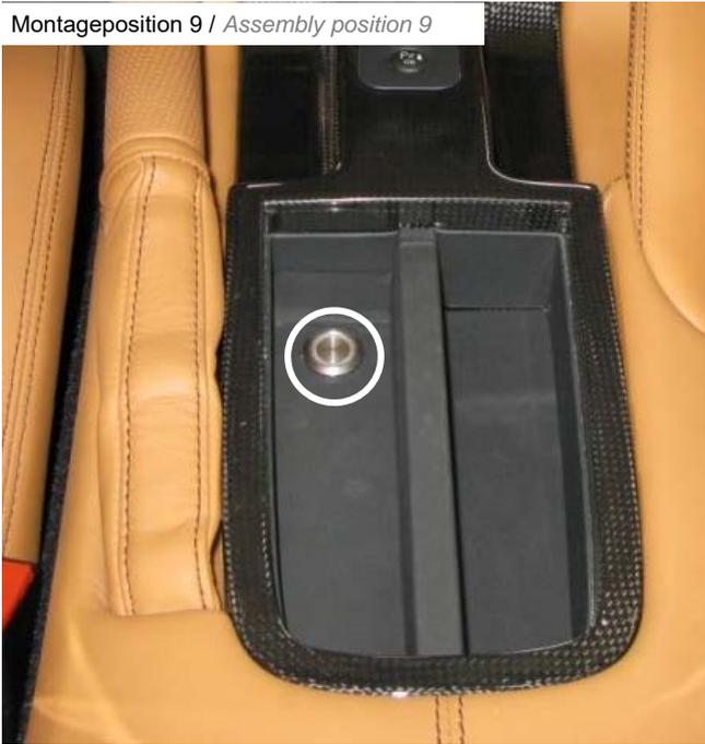
Für die Montage des Tasters muss ein Loch in das Ablage gebohrt werden.
