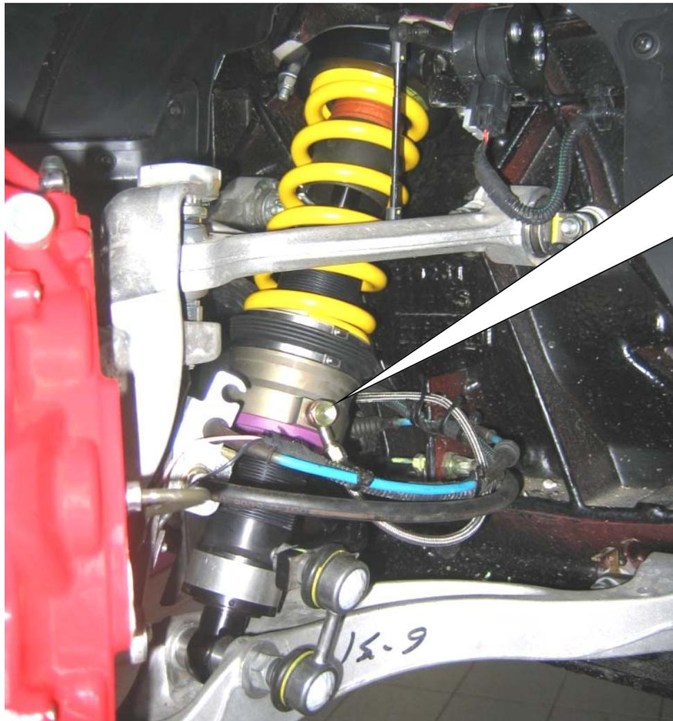
HLS Ringzylinder so positionieren, dass dieser mit der Hydraulikverschraubung zum Fahrzeugheckseite zeigt.
