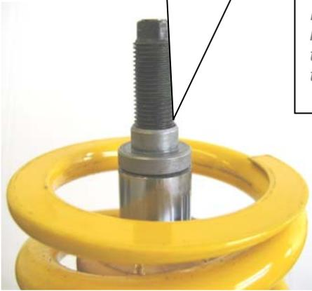
Original Stützlager aufstecken und mit der mitgelieferten Stopmutter und Original Unterlegscheibe verschrauben. Das Anzugsdrehmoment der Kolbenstangenbefestigung beträgt 35 Nm. Die Montagehinweise zum Einbau des Federbeines in das Fahrzeug, sowie die Anzugsdrehmomente der Federbeinbefestigung, entnehmen Sie bitte den Unterlagen des Fahrzeugherstellers.
