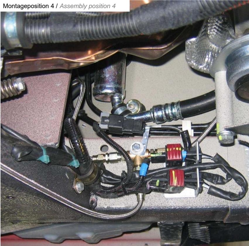
Hydraulikleitung ( 3900 mm) mit dem Verteiler verbinden.
