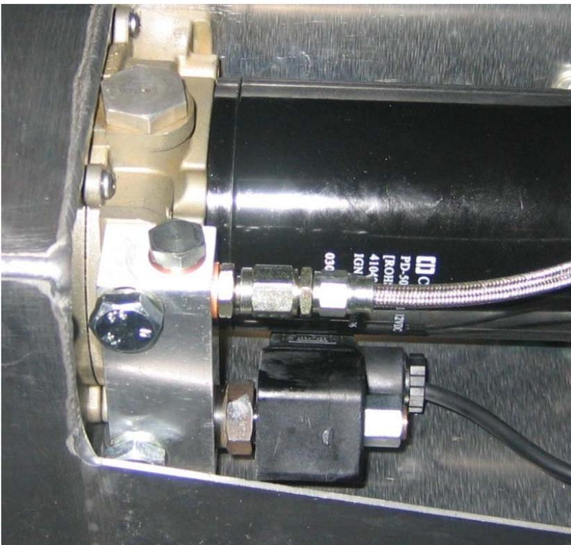
Absperrstopfen herausdrehen. Mitgelieferten Anschlussadapter mit einer Dichtscheibe montieren. Anschließend Hydraulikleitung an dem zuvor montierten Adapter aufdrehen.
