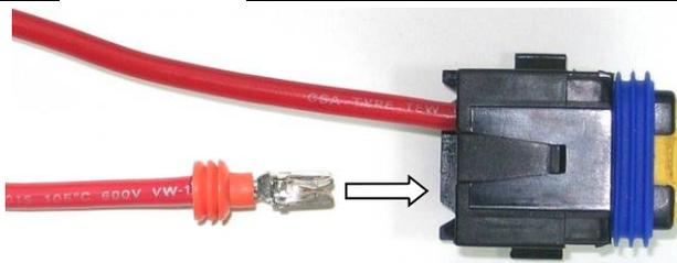
Fertig montierte Plusleitung in den Sicherungshalter einrasten.
