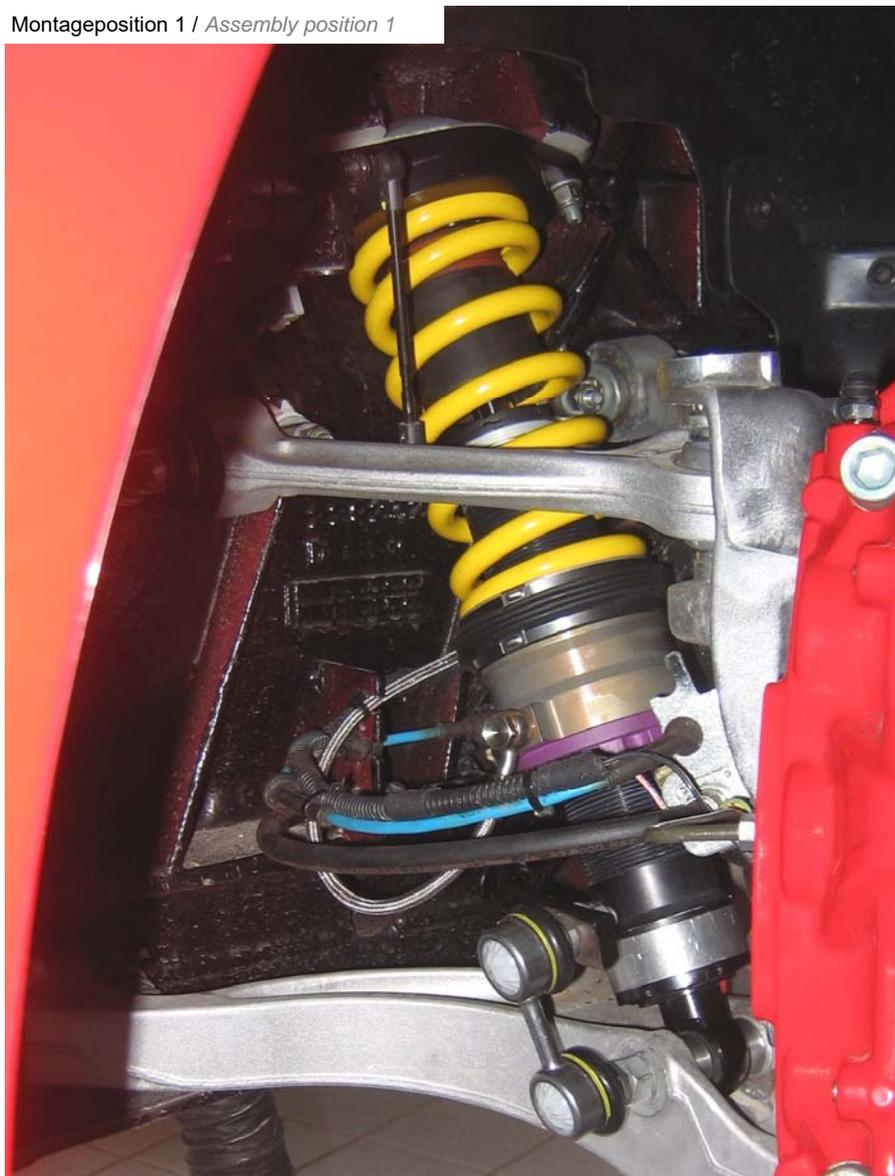
Hydraulikleitung ( 2100 mm) am HLS Ringzylinder mit der mitgelieferten Hohlsschraube und 2 Dichtscheiben montieren.
