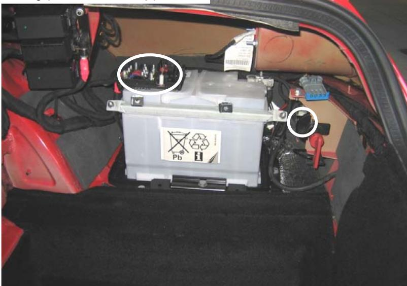
Plusleitung an der Batterie mit einer Sicherung verschrauben und die Masseleitung nach dem Notausschalter verschrauben.
