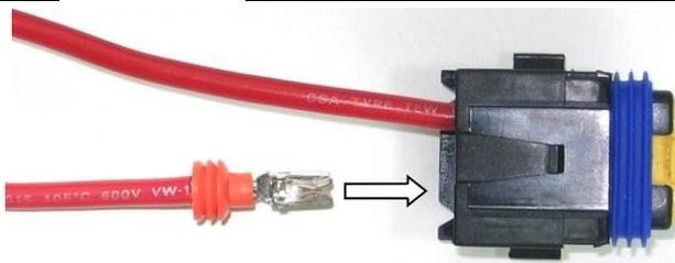
Fertig montierte Plusleitung in den Sicherungshalter einrasten.
