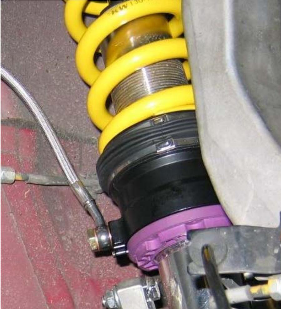
Hydraulikleitung (1340 mm) am HLS Ringzylinder mit der mitgelieferten Hohlsschraube und 2 Dichtscheiben montieren.
