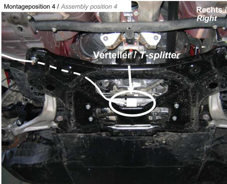
Hydraulikleitung (1340 mm) mit dem Verteiler verbinden. Anschließend Hydraulikleitung mit den mitgelieferten Kabelbinder an befestigen. Kabelbinder erst nach vollständiger Leitungsverlegung festziehen.
