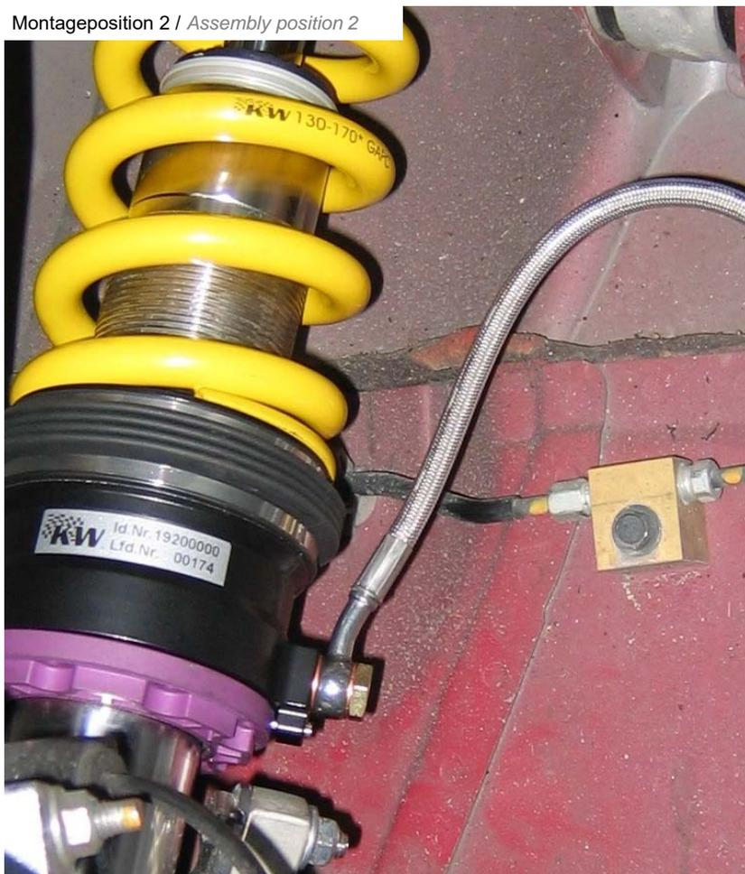
Hydraulikleitung (1340 mm) am HLS Ringzylinder mit der mitgelieferten Hohl- schraube und 2 Dichtschiben montie- ren.
