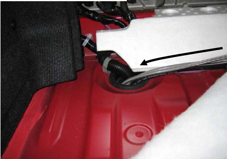
Spannungsversorgungsleitung mit dem Hydraulikaggregat verbinden.
