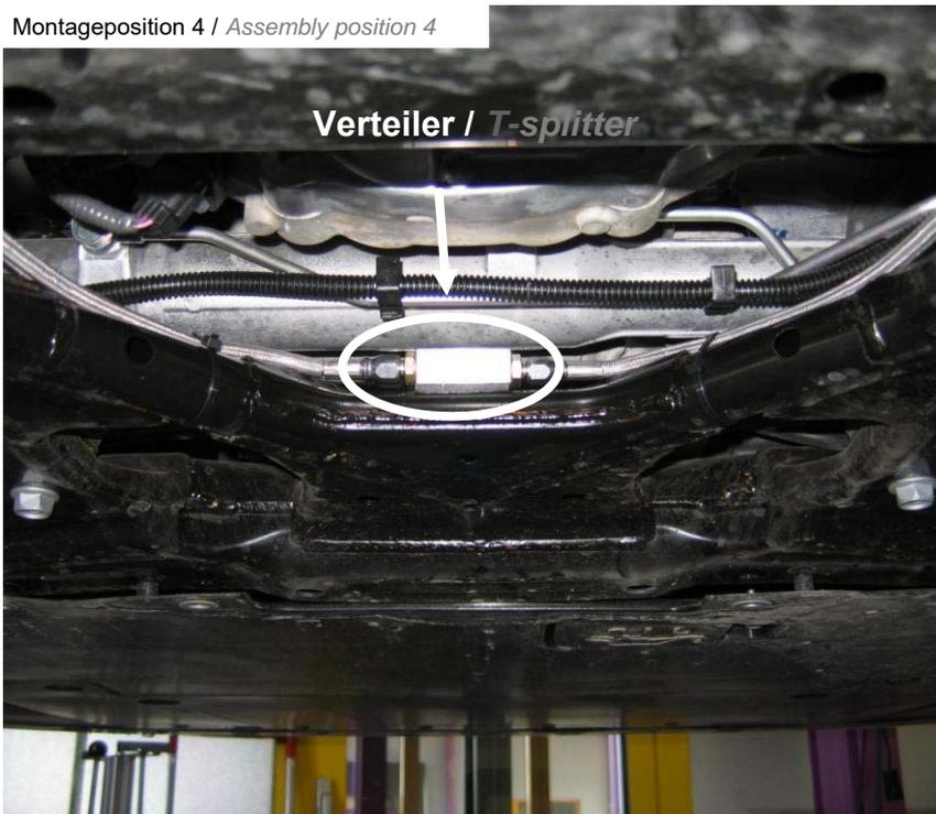
Hydraulikleitung (4300 mm) mit dem Verteiler verbinden.
