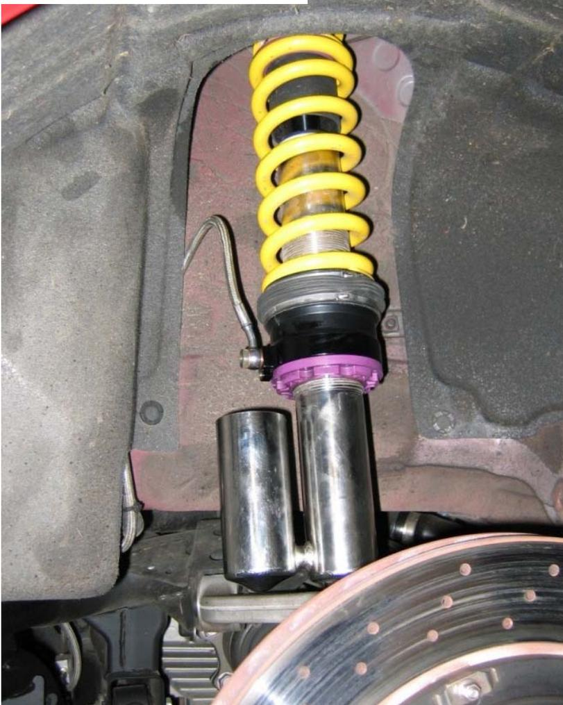
Hydraulikleitung (1100 mm) am HLS Ringzylinder mit der mitgelieferten Hohl-schraube und 2 Dichtscheiben montieren. HLS Ringzylinder so positionieren, dass dieser mit der Hydraulikverschraubung schräg zur Fahrzeugheckseite innen zeigt.
