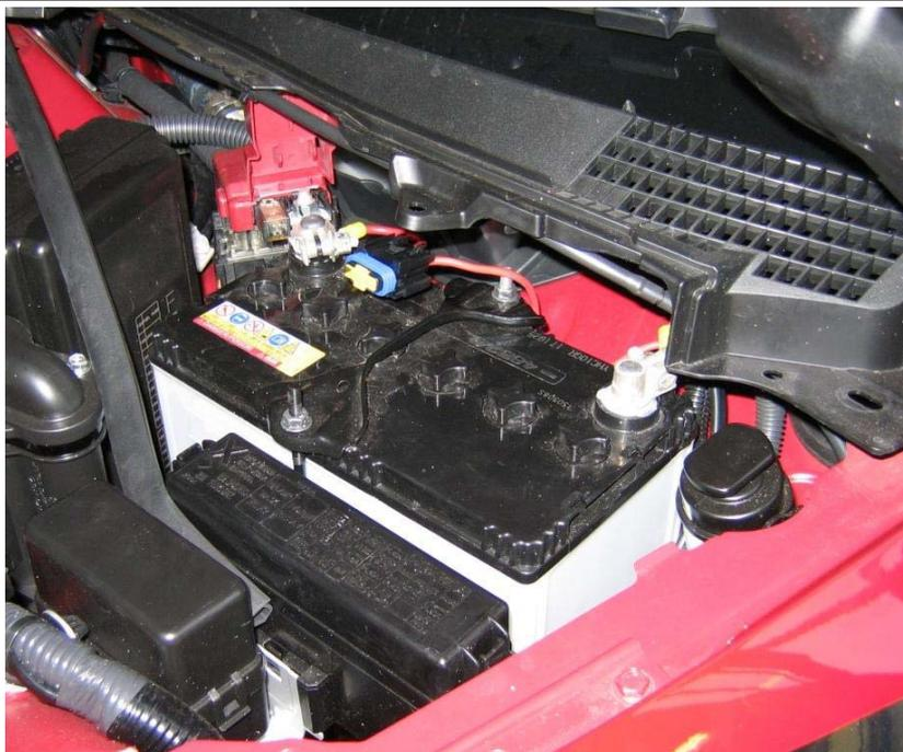
Masseleitung und Plusleitung an der Batterie verschrauben.
