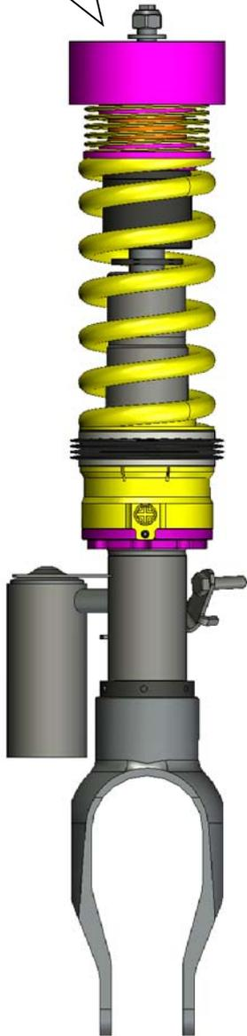
Die Nase an der Kolbenstangenaufnahme muss entfernt werden.
