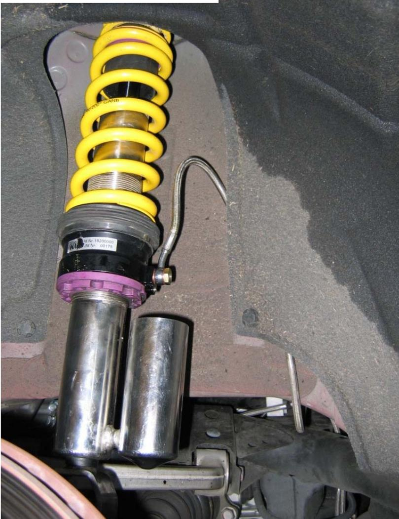
Hydraulikleitung (1100 mm) am HLS Ringzylinder mit der mitgelieferten Hohl-schraube und 2 Dichtscheiben montieren. HLS Ringzylinder so positionieren, dass dieser mit der Hydraulikverschraubung schräg zur Fahrzeugheckseite innen zeigt.
