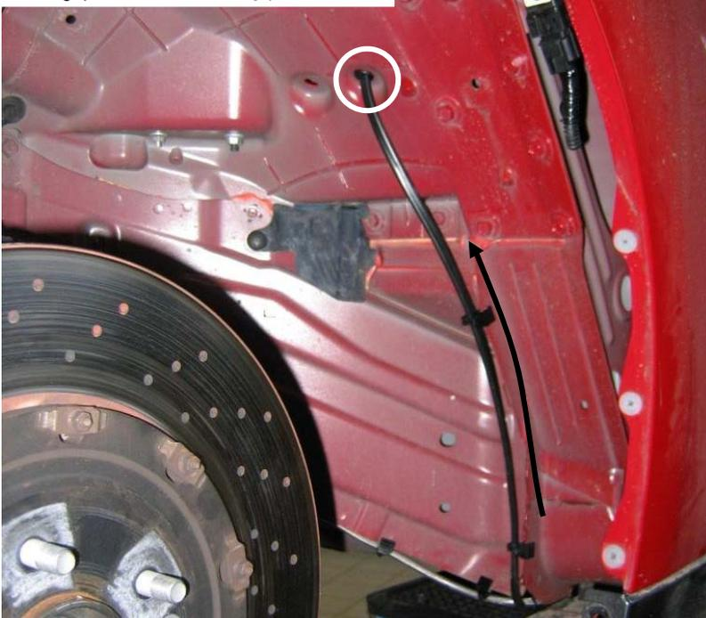
Spannungsversorgungsleitung mit der mitgelieferten Kabeldurchführungsstülpe in den Motorraum verlegen.
