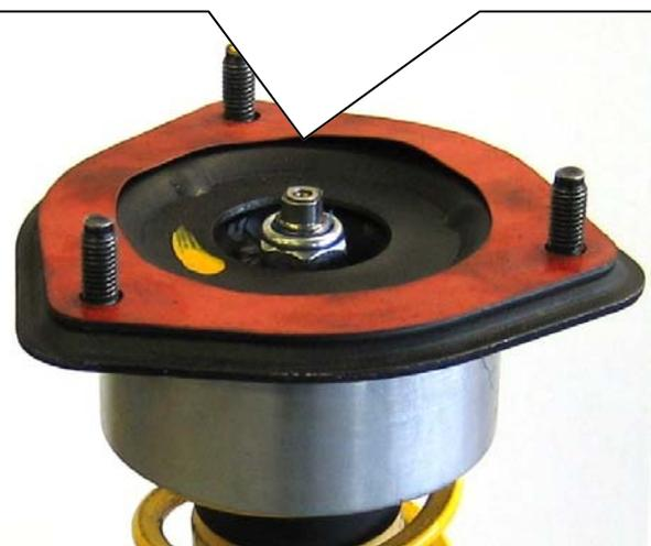
HLS Ringzylinder so positionieren, dass dieser mit der Hydraulikverschraubung zur Fahrzeugheckseite innen zeigt.
