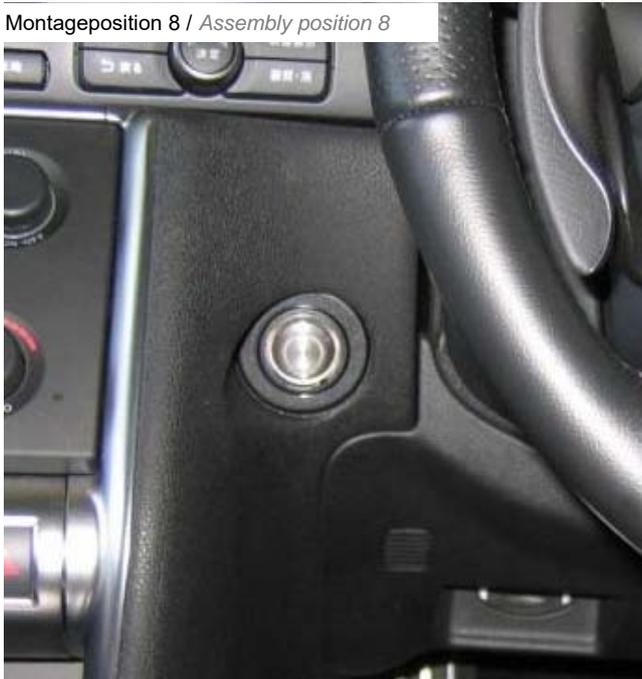
Für die Montage des Tasters muss ein Loch in das Armaturenbrett gebohrt werden.
