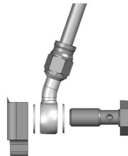
Hydraulikleitung (1340mm) mit dem Verteiler verbinden. Anschließend Hydraulikleitung mit den mitgelieferten Kabelbinder an der Strebe befestigen. Kabelbinder erst nach vollständiger Leitungsverlegung festziehen. Sollte es vorkommen, dass die Hydraulikleitung über einer Scharfen Kante verläuft, ist die Hydraulikleitung mit dem Spiralband zu schützen.
