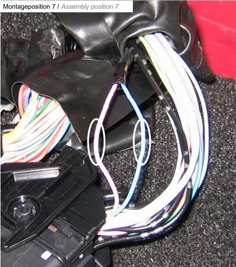
Mitgelieferte CAN Leitungen an die CAN Leitung des Steuergeräts seitlich anlöten. Auf keinen Fall die Original CAN Leitungen durchtrennen.
