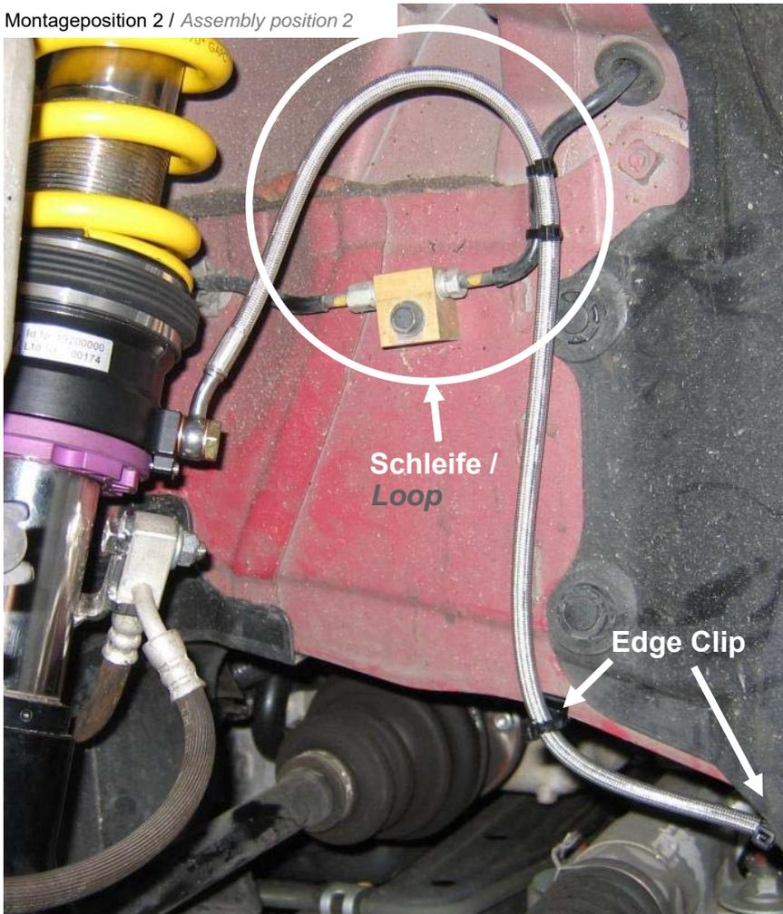
Hydraulikleitung mit Befestigungsbinder Edge Clips und Kabelbinder befestigen. Kabelbinder erst nach vollständiger Leitungsverlegung festziehen
