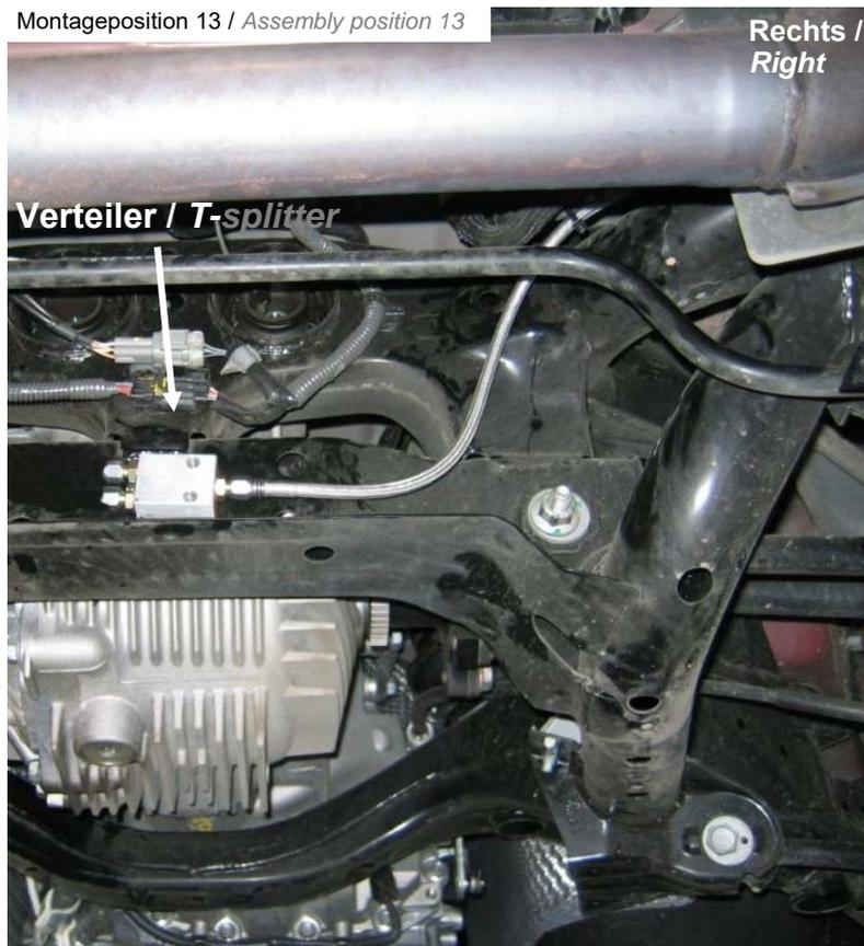
Hydraulikleitung (1100 mm) mit dem Verteiler verbinden. Anschließend Hydraulikleitung mit den mitgelieferten Kabelbinder befestigen. Kabelbinder erst nach vollständiger Leitungsverlegung festziehen.
