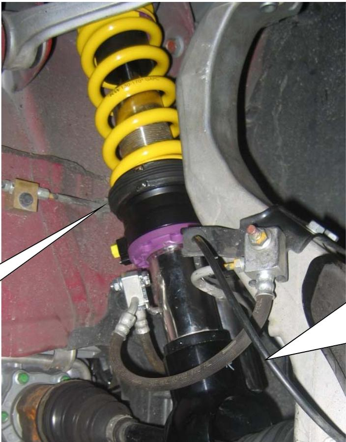
HLS Ringzylinder so positionieren, dass dieser mit der Hydraulikverschraubung zur Fahrzeugheckseite innen zeigt.
