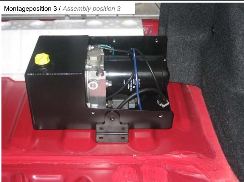
Anschließend Bohrungen des Montagehalters markieren.
