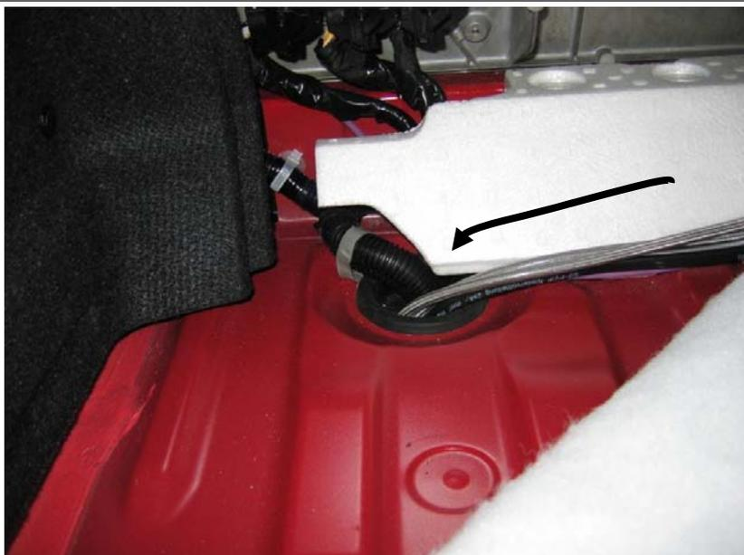
Hydraulikleitung (1570 mm) entlang der anderen Hydraulikleitung verlegen und mit Kabelbinder befestigen.
