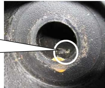
Original Stützlager aufstecken und mit der mitgelieferten Stoppmutter verschrauben. Das Anzugsdrehmoment der Kolbenstangenbefestigung beträgt 35 Nm. Die Montagehinweise zum Einbau des Federbeines in das Fahrzeug, sowie die Anzugsdrehmomente der Federbeinbefestigung entnehmen Sie bitte den Unterlagen des Fahrzeugherstellers.
