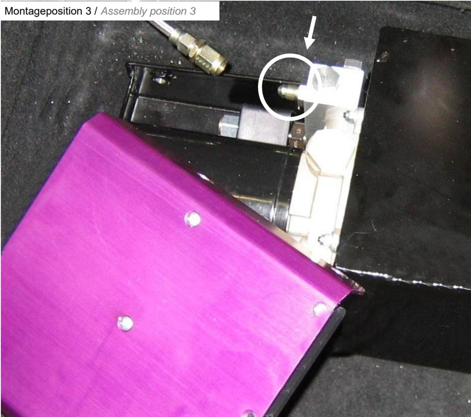
Abdeckung des Hydraulikaggregats demontieren.
