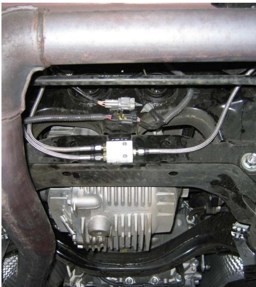
Hydraulikleitung (1570 mm) mit dem Verteiler verbinden. Anschließend Hydraulikleitung mit den mitgelieferten Kabelbinder befestigen. Kabelbinder erst nach vollständiger Leitungsverlegung festziehen. Sollte es vorkommen, dass die Hydraulikleitung über einer Scharfen Kante verläuft, ist die Hydraulikleitung mit einem Spiralband zu schützen.
