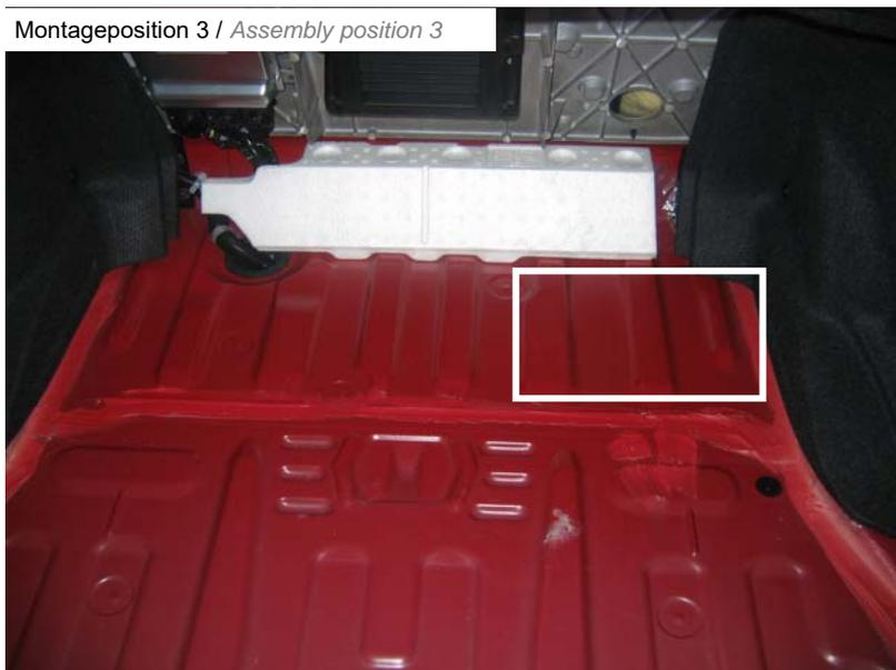
Innenraumteppich entfernen und Hydraulikaggregat positionieren.
