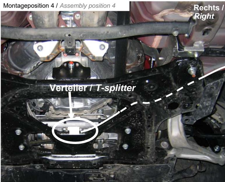
Hydraulikleitung (1340 mm) mit dem Verteiler verbinden. Anschließend Hydraulikleitung mit den mitgelieferten Kabelbinder an Befestigungen festziehen. Kabelbinder erst nach vollständiger Leitungsverlegung festziehen.
