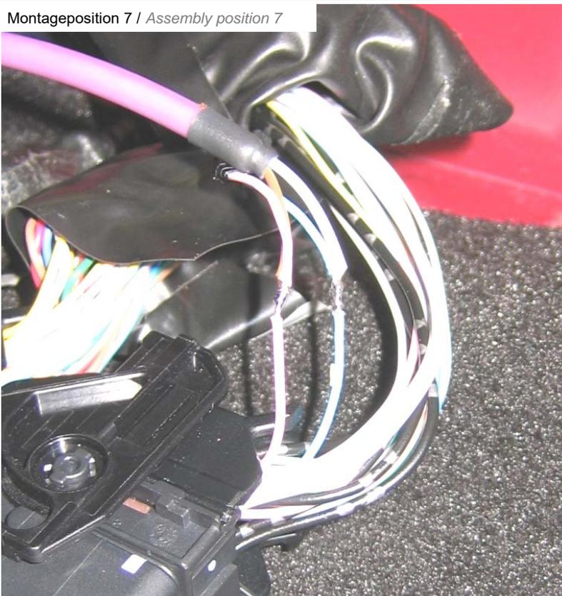
Mitgelieferte CAN Leitung (**Kabelfarbe weiß**) an die originale Leitung **Stecker Pinreihe 2 Pin K (Kabelfarbe blau)** anlöten. Andere Leitung (**Kabelfarbe braun**) an die originale Leitung **Stecker Pinreihe 2 Pin J (Kabelfarbe pink)** anlöten. Anschließend Lötstellen und Leitung isolieren.
