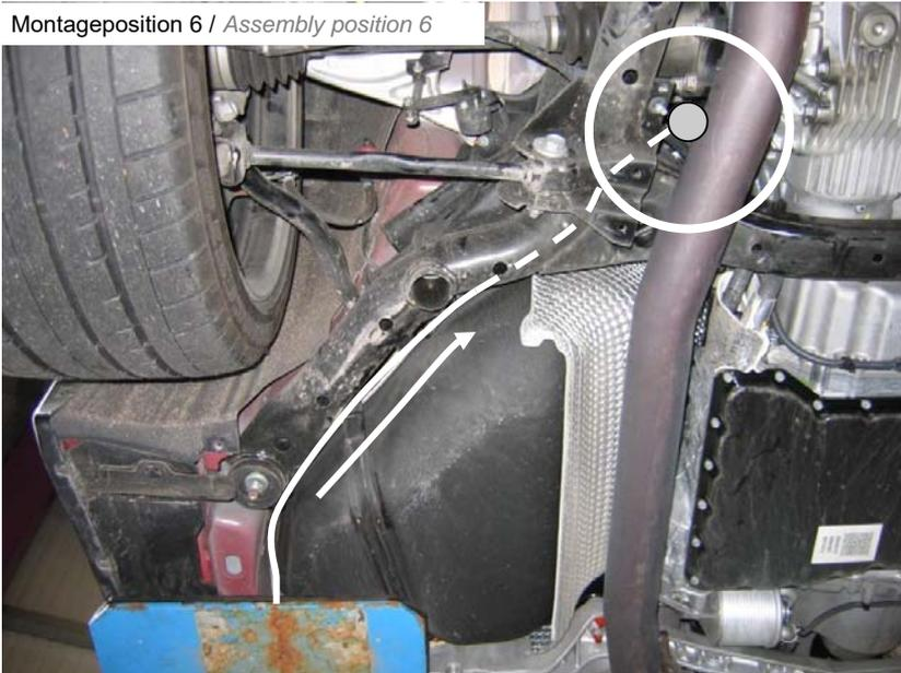
Hydraulikleitung durch die serienmäßige Öffnung verlegen und mit Kabelbinder befestigen.
