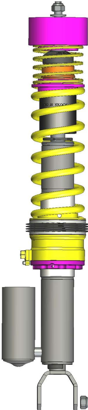
Die Nase an der Kolbenstangenaufnahme muss entfernt werden.
