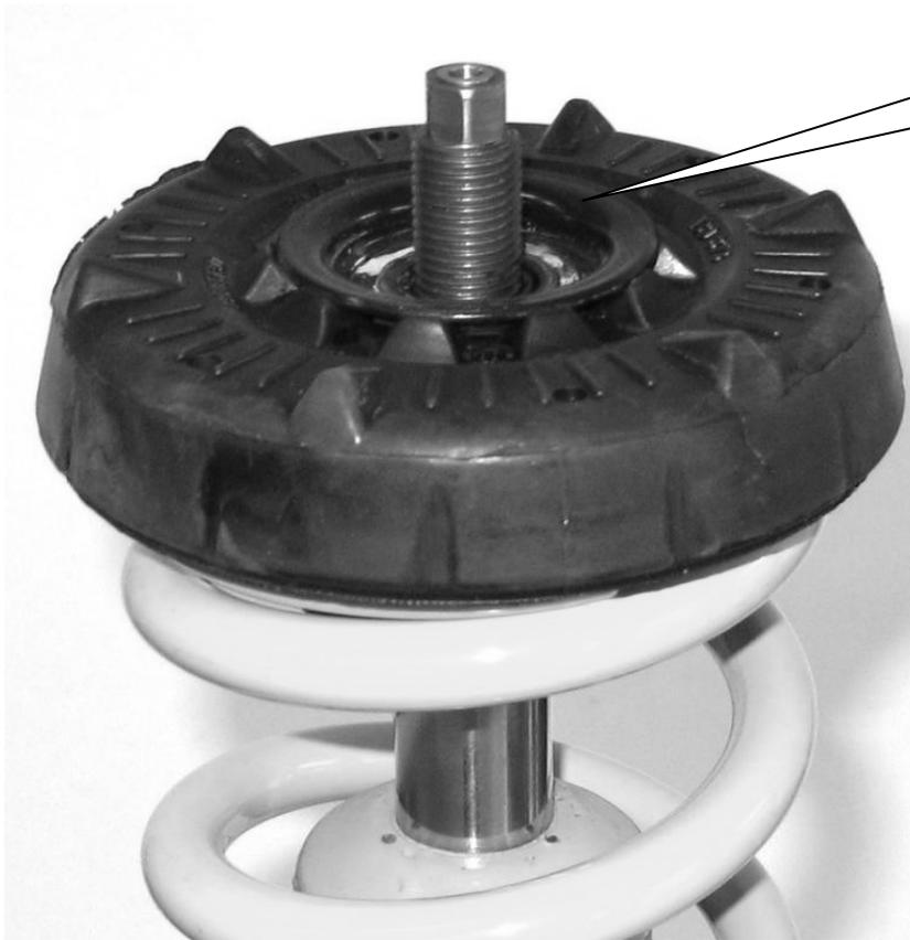
Originale Stützlagereinheit auf das Federbein aufsetzen.
