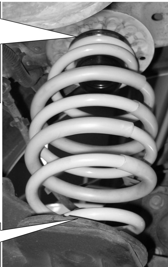
Am unteren Ende der Feder wird die Original Federunterlage weiterverwendet.
