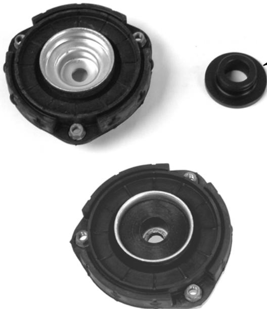
Original Domlager aufsetzen und mit der im Lieferumfang enthaltenen Mutter verschrauben. Das Anzugsdrehmoment der Kolbenstangenbefestigung beträgt 50 Nm. Die Montagehinweise zum Einbau des Federbeines in das Fahrzeug, sowie die Anzugsdrehmomente der Federbeinbefestigung, entnehmen Sie bitte den Unterlagen des Fahrzeugherstellers.
