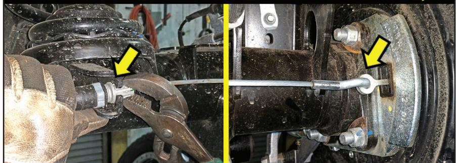
**INSTALL REAR TRACK BAR RELOCATION BRACKET...**
