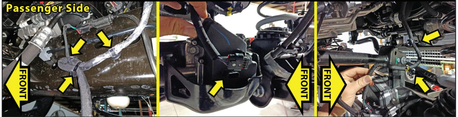
**REMOVE BRAKE LINE BRACKET...**
