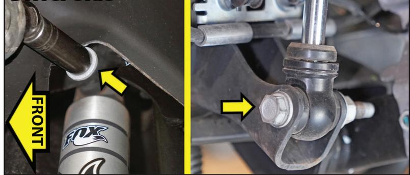
**ATTACH BRAKE LINE BRACKET TO LOWER CONTROL ARM...**
