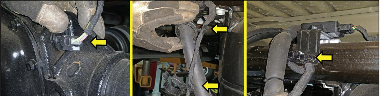
**RECONNECT E-BRAKE TO AXLE HOUSING & BRAKE ASSEMBLY...**
