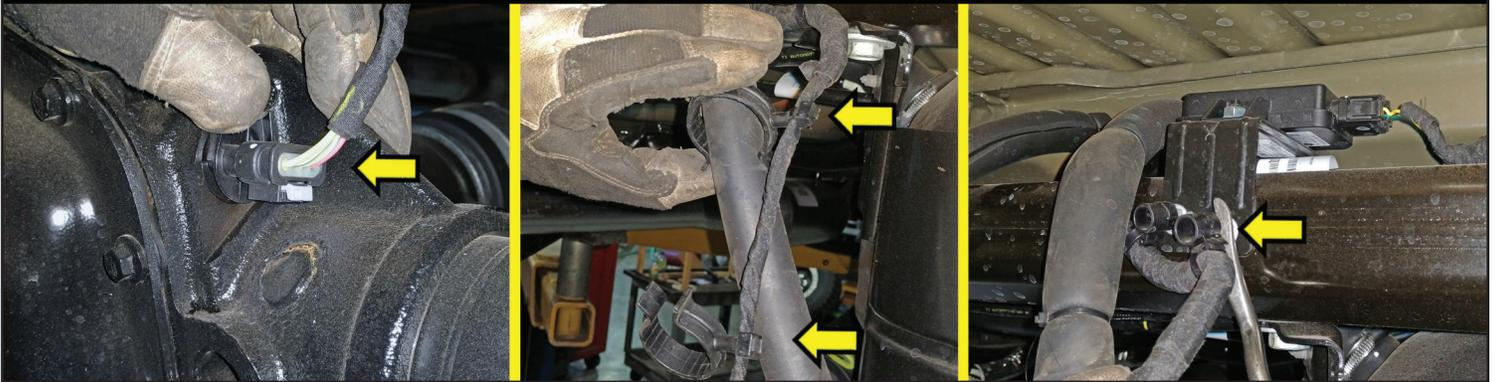
**DISCONNECT E-BRAKE FROM AXLE HOUSING & BRAKE ASSEMBLY...**
