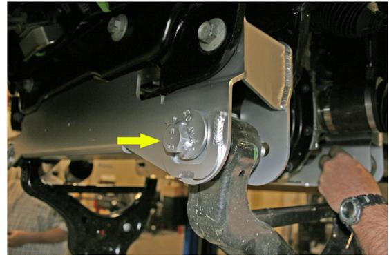
**27) TIGHTEN THESE FASTENERS...**
